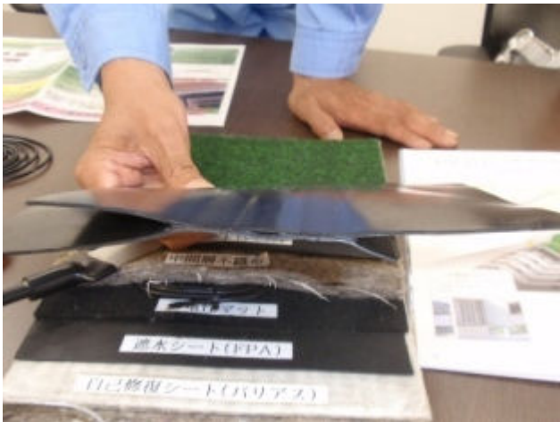
遮水シートの説明、遮水シートは二重化にしており安全性を更に高める
