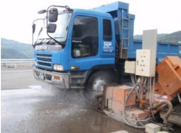
ダンプに付着した廃棄物の洗浄中、処分場外へ廃棄物が出ないように対策
