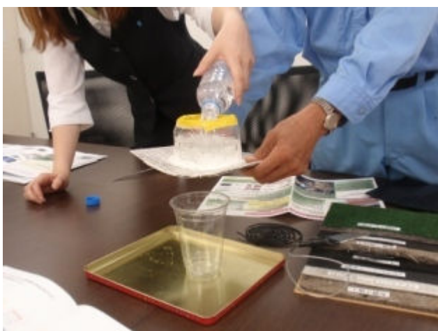
廃棄物から発生する浸出水、最新技術の自己修復シートで実演
